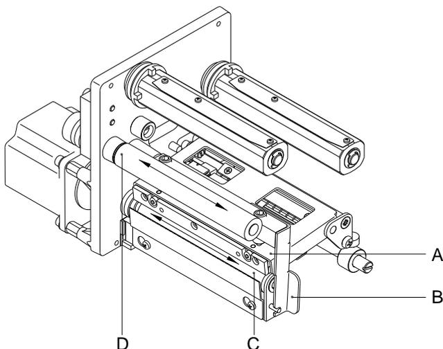
Eine Verschmutzung der Druckwalze führt zu einer schlechteren Druckqualität und kann außerdem zu Beeinträchtigungen des Materialtransports führen.
