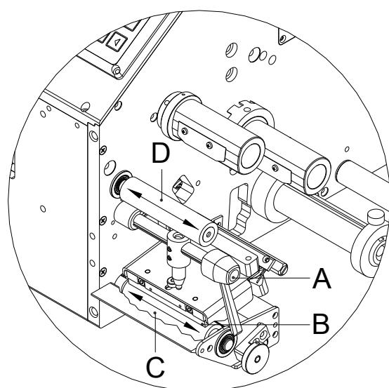
Het is niet nodig om de printsysteem uit te schakelen wanneer het printsysteem moet worden gereinigd. Wacht echter, nadat de printkop omhoog geklapt is, nog twee minuten voordat u het printsysteem gaat reinigen. Wanneer het printsysteem wordt uitgeschakeld, wordt ook de inhoud van het werkgeheugen gewist.
