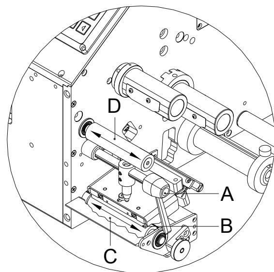
Eine Verschmutzung der Druckwalze führt zu einer schlechteren Druckqualität und kann außerdem zu Beeinträchtigungen des Materialtransports führen.
