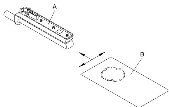
Fotocellsbrytaren kan bli smutsig genom pappersdamm. Därigenom kan identifieringen av etikettarnas början påverkas negativt.
