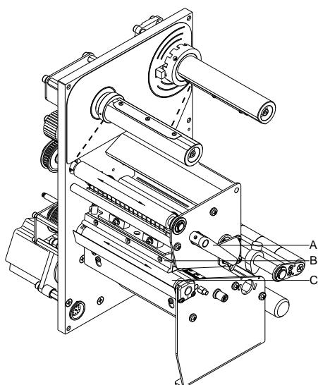
Het is niet nodig om de printer uit te schakelen wanneer de printer moet worden gereinigd. Wacht echter, nadat de printkop omhoog geklapt is, nog twee minuten voordat u de printer gaat reinigen. Wanneer de printer wordt uitgeschakeld, wordt ook de inhoud van het werkgeheugen gewist.
