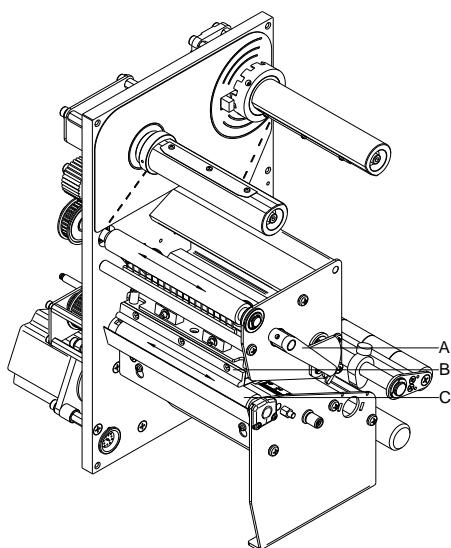
Painotelan likaantuminen johtaa huonompaan painojälkeen ja voi myös huonontaa etikettien kuljetusta.
