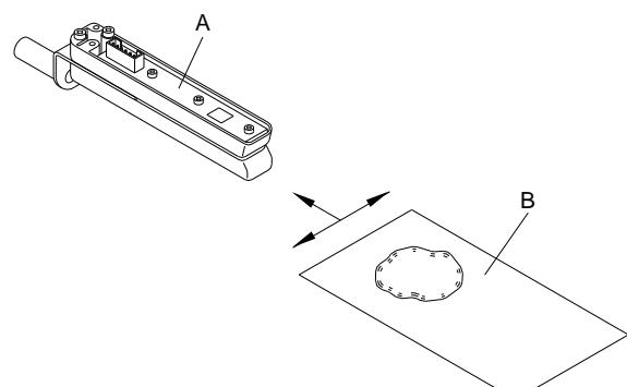
Die Etikettenlichtschranke kann durch Papierstaub verschmutzen. Dadurch kann die Etikettenabtastung beeinträchtigt werden.
