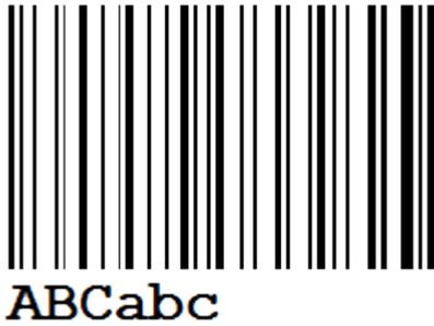
Der **Code 128** ist ein universeller, alphanumerischer Barcode der hauptsächlich im Speditions-/Transportgewerbe, auf Ausweisen und in der Lagerhaltung/Distribution eingesetzt wird.
