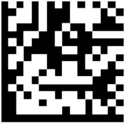
Der **GS1 DataMatrix** ist eine Sonderform des [DataMatrix](#) und wird vor allem im Handel und der Industrie, hauptsächlich bei der Waren- und Palettenauszeichnung eingesetzt.
