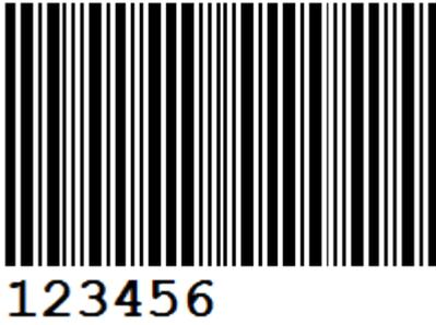
Der **Code 2/5 Industrial** ist ein numerischer Barcode der die Ziffern 0-9 beinhaltet. Der Code wird hauptsächlich in der Industrie und vor allem in der Transport-/Lagertechnik angewandt. Die Verwendung der Prüfziffer ist nicht vorgeschrieben.
