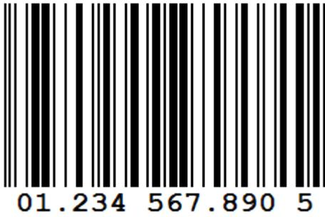
Der **Identcode** wird von der Deutschen Post AG (DHL) verwendet und dient der automatischen Verteilung der Frachtsendung in den Postzentren. Der Identcode ist eine Anwendung des [Code 2/5 Interleaved](#), jedoch mit einer anders berechneten Prüfziffer und einer abweichenden Formatierung der Klarschriftzeile.
