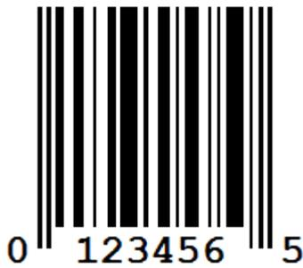
Der **UPC-E** Code ist eine komprimierte Version des [UPC-A](#) und wird überall dort eingesetzt, wo nur geringer Platz zur Verfügung steht. Durch die Methode der Nullunterdrückung kann eine 12-stellige [UPC-A](#) Nummer in eine 6-stellige **UPC-E** umgewandelt werden. Bei der Rückkonvertierung erfolgt eine Wiederauffüllung der Nullen und es entsteht somit wieder eine 12-stellige Komplettnummer.
