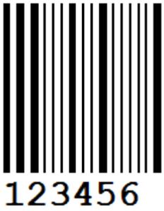
Der **Pharmacode** ist ein einfacher, numerischer Barcode der vom Unternehmen Laetus in Umlauf gebracht wurde. Er wird in der pharmazeutischen Industrie zur Packmittelkontrolle bzw. zur Steuerung von Verpackungsmaschinen verwendet.
