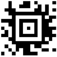
Der **Aztec Code** ist ein 2D Matrix-Code in dessen Mittelpunkt sich das Suchelement befindet das aus mehreren auf einem Raster angeordneten quadratischen Modulen besteht. Der **Aztec Code** wird hauptsächlich im Transportwesen wie z.B. für Online Tickets der Deutschen Bahn verwendet.
