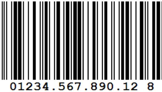
Der **Leitcode** wird von der Deutschen Post AG (DHL) verwendet und dient der automatischen Verteilung der Frachtsendung in den Postzentren. Der Leitcode ist eine Anwendung des [Code 2/5 Interleaved](#), jedoch mit einer anders berechneten Prüfziffer und einer abweichenden Formatierung der Klarschriftzeile.
